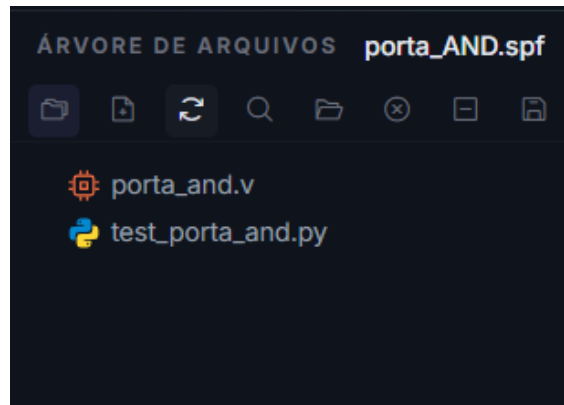
Figura2: No projeto porta_AND, o testbench test_porta_and.py aparece na mesma árvore da fonte porta_and.v e é identificado pelo ícone Python.
